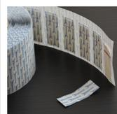
Ref. NAI 50: Tira adhesiva especial de doble cara, con anchura de 5x2 cm., especial para realizar sujeciones en peldaños sin dejar restos de adhesivo hasta 150 días / Tiene un alto gramaje y un adhesivo especial. / Aplicar en interiores y exteriores / Se recomienda colocar mínimo 6-7 tiras por protector.
